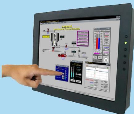
**Рис. 1. Промышленный 15.1" TFT-монитор с сенсорным экраном, устойчивый анодированный алюминевый или стальной кожух.**
